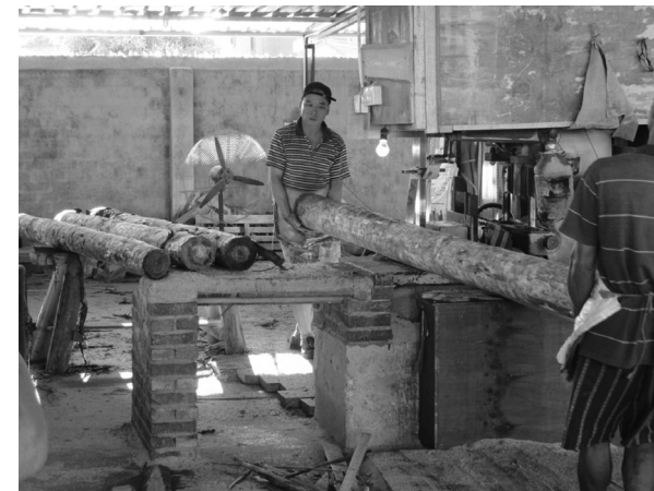
製材機で製材の作業を行う作業者。 人力で丸太を送っている
