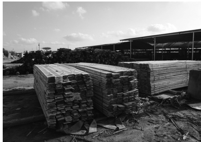
製材工場。手前が製品。奥にはこれから製材される丸太が見える
