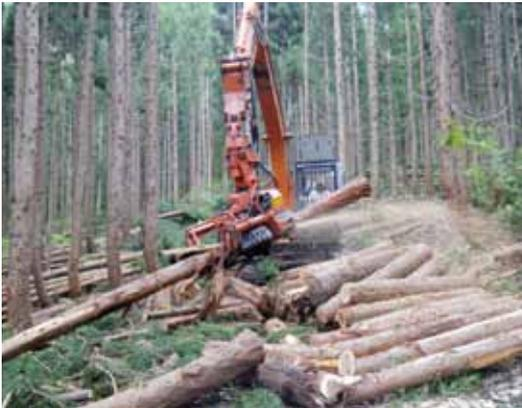
プロセッサによる枝払い・造材作業
