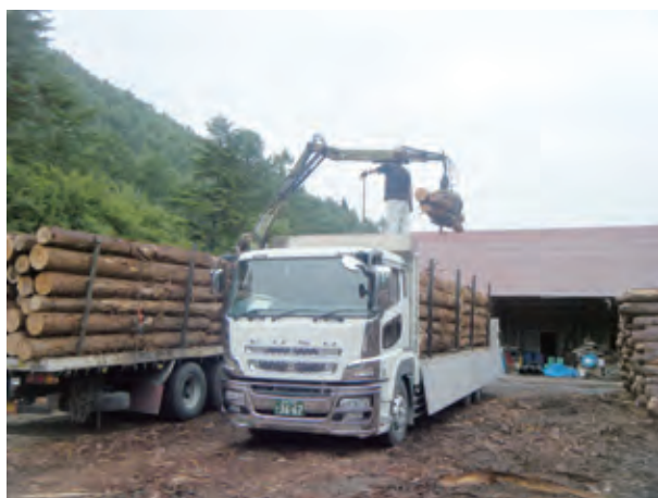
合板用材を積んだ15t積トラック
