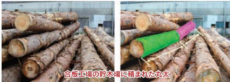
能林業機械が導入され、造材にはプロセスサという枝を払い、玉切をする機械が使われています。本来、曲りを見るには丸太の先端から見て造材の判断をしますが、プロセスサによる造材では、丸太の先端から見ることは困難です。条件が合えば丸太の元から見ることもできますが、側面から見る状況が多いのが実情です。オペレーターに対しては、判らないときは機械から下りて見るように指導しています。しかし、側面から直材に見える場合には、玉切りを行ってしまいます。逆に曲りの判断に時間を費やしていると、そのコストが不利に働いてしまいます。
