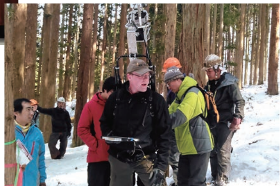
バックパックレーザー計測装置による現地調査
