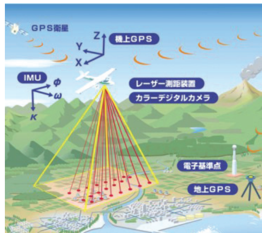
航空レーザー測量 原理図
